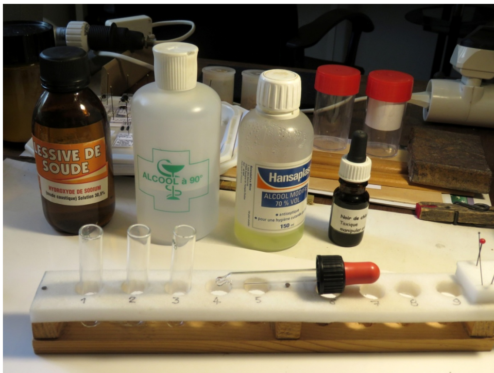
Soude, alcool et colorant - Râtelier avec tubes pour macération
